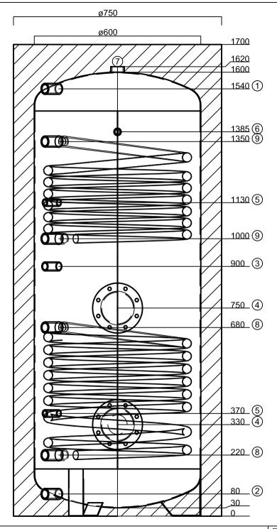
Wärmetauscher: max. Betriebsdruck 10bar max. Betriebstemperatur: 95°C
